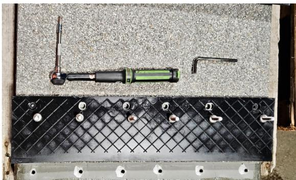
3. Notwendige Werkzeuge zum Heraus- und Eindrehen sowie zum Anziehen der Zylinderkopfschraube mit einem 7 mm Innensechskant und sonstiges Werkzeug.
